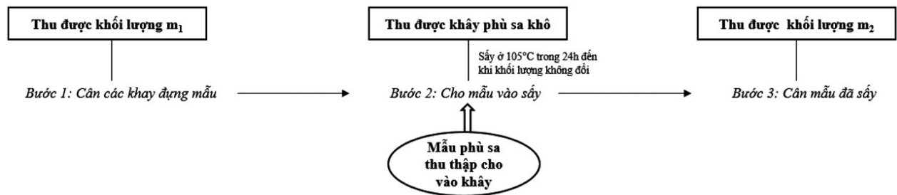
Hình 5. Sơ đồ các bước xử lý mẫu phù sa lắng đọng
